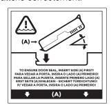
Saisissez la batterie en présentant la patte noire à l'avant de la batterie vers le haut, face au loquet du volet (cette patte permet d'éjecter la batterie). Présentez le bord arrière en premier en le poussant doucement sous les deux loquets de batterie. Faites pivoter le bord avant vers le bas pour le mettre en place.
