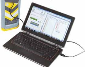
C.A.T Manager peut désactiver et réactiver des fonctionnalités C.A.T4 (par exemple, l'estimation de profondeur et les alertes) afin de rendre l'utilisation plus simple.
